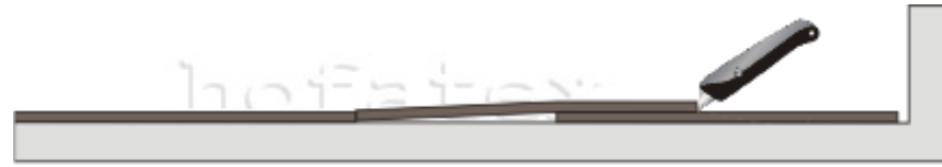
Abb. 2 Schnittkante für Bodenlegermesser
