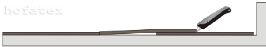
Abb. 2 Schnittkante für Bodenlegermesser
